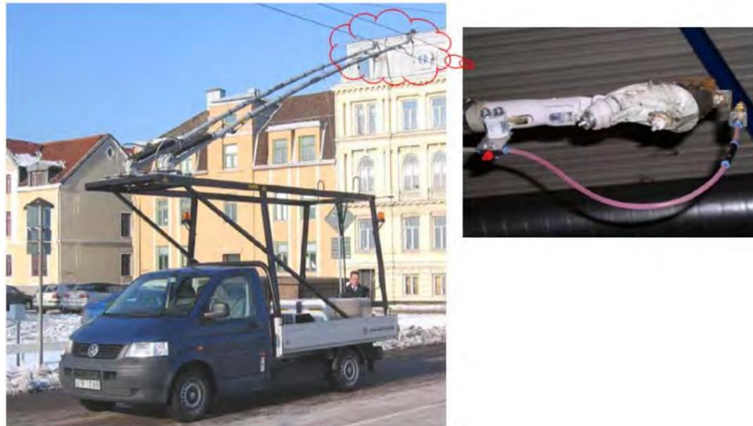
Figure 21 : Véhicule léger pour dégivrage
