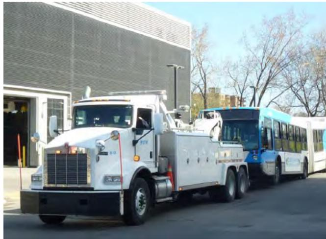
Figure 13 : Camion pour les opérations de dépannage
