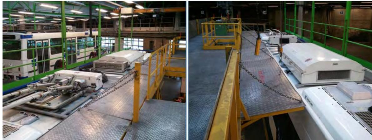
Figure 8 : Système de panneaux mobiles (Lausanne, Suisse)
