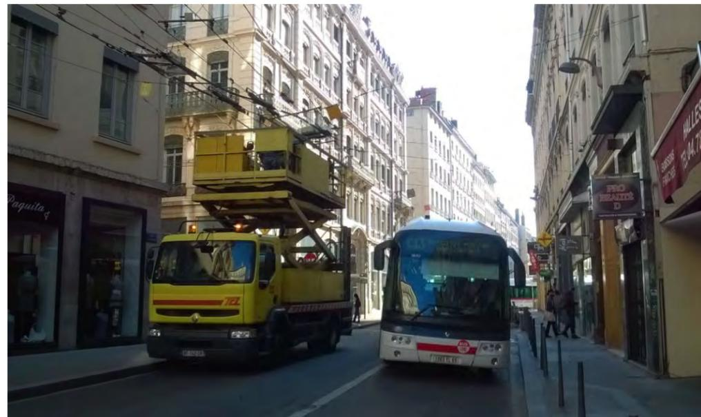
Figure 24 : Camion à plate-forme élévatrice
