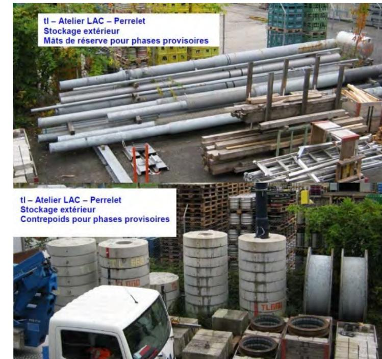
Figure 16 : Stockage des mâts et des contrepoids chez Transports Lausanne
